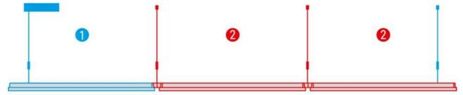
① Pendel-Einzelleuchte / Suspended individual luminaire
